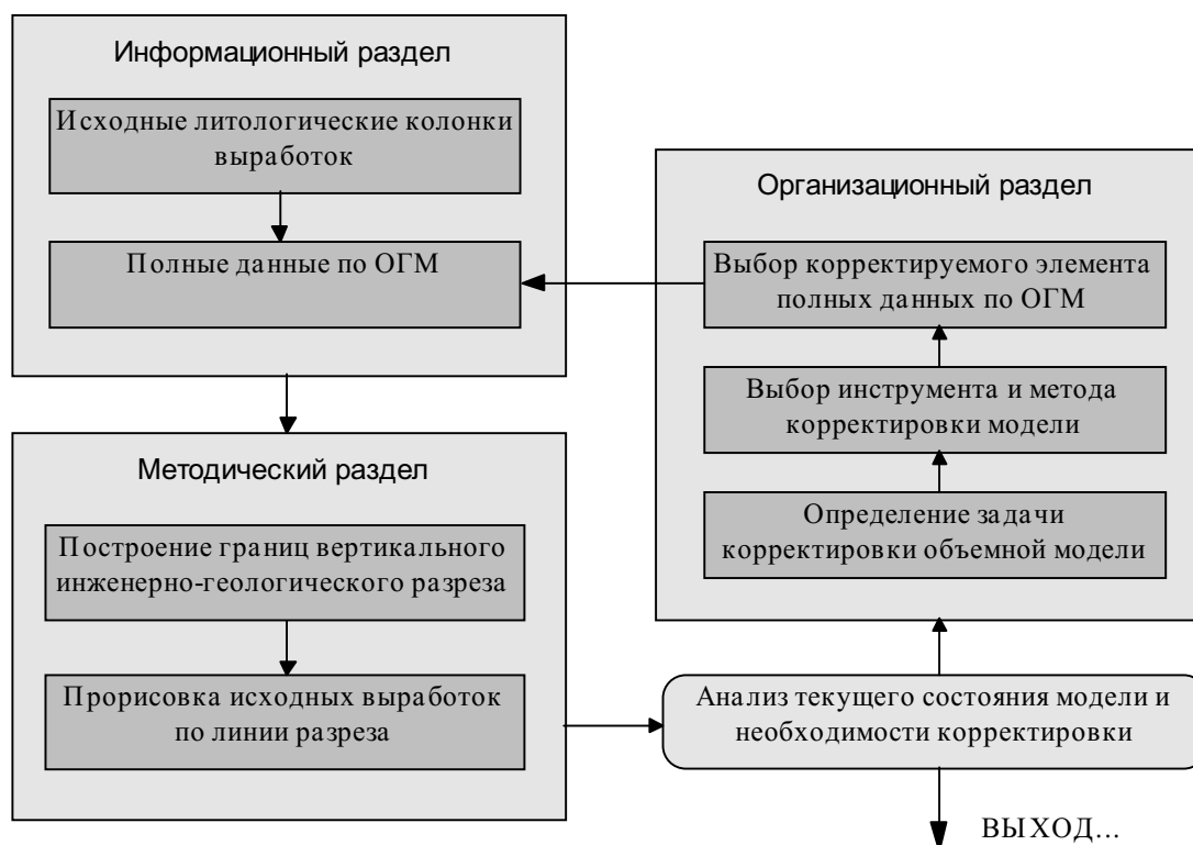
Рис. 3 Структура объемной геологической модели
