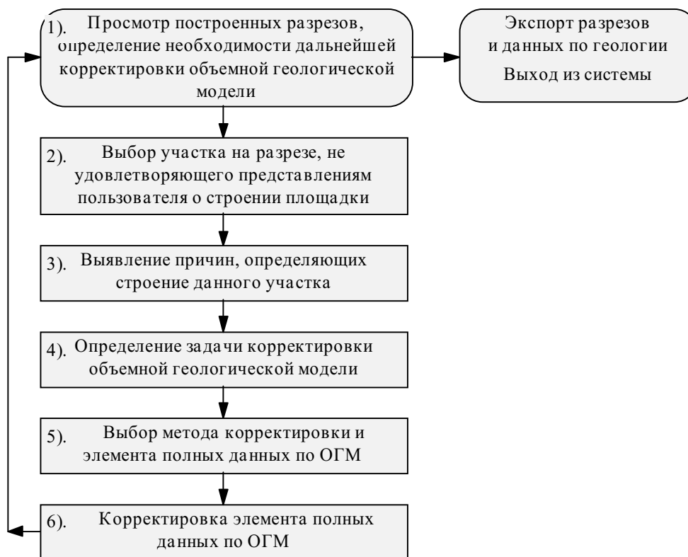
Рис. 10 Общая последовательность корректировки ОГМ
